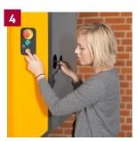
1 Compacte los residuos y expulse la bala terminada. 2 Extraiga y almacene la bala hasta su recogida. 3 Los cilindros cruzados garantizan una compresión estable y una altura global baja. 4 La bala se expulsa mediante un proceso seguro con ambas manos.
