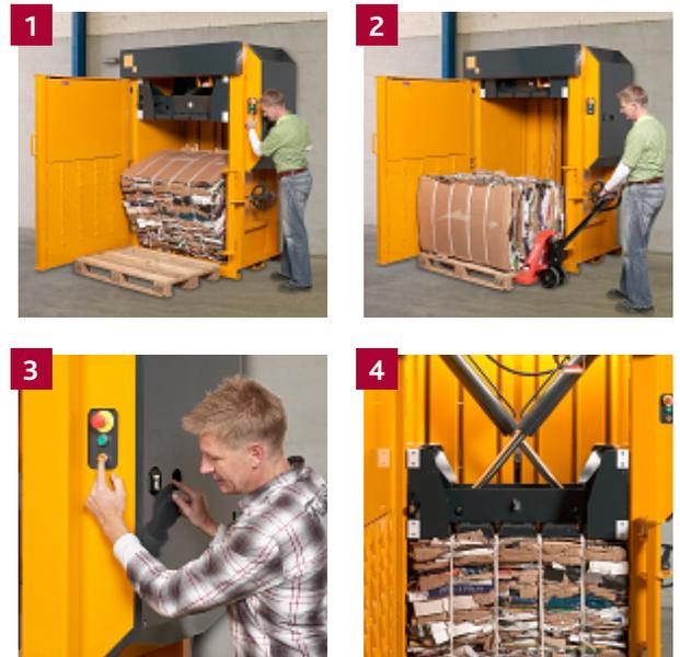
**1** Compacte los residuos y expulse la bala terminada. **2** Extraiga y almacene la bala hasta su recogida. **3** La bala se expulsa mediante un proceso seguro con ambas manos. **4** Los cilindros cruzados garantizan una compresión estable y una altura global baja.
