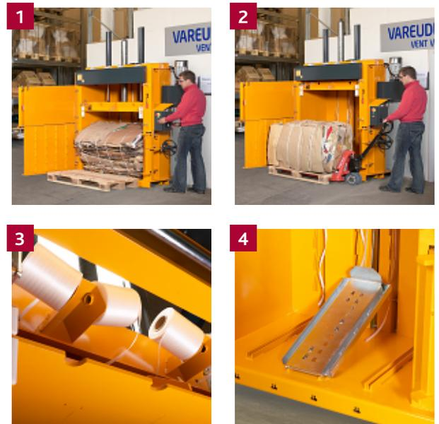
**1** Compacte los residuos y expulse la bala terminada. **2** Extraiga y almacene la bala hasta su recogida. **3** Los rollos de correas se rempazan fácilmente en la parte delantera de la máquina. **4** Un sistema de extracción eficaz y silencioso garantiza una manipulación sencilla de la bala.
