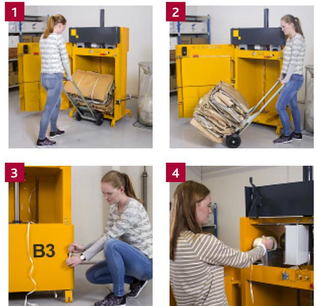
**1** Logre un alto grado de compactación de sus residuos. **2** Utilice el carro suministrado para retirar el fardo terminado. **3** Un bloqueo de eje garantiza la seguridad y facilidad de apertura de la puerta inferior. **4** Los rodillos de fleje se encuentran en la parte delantera y son fáciles de sustituir.
