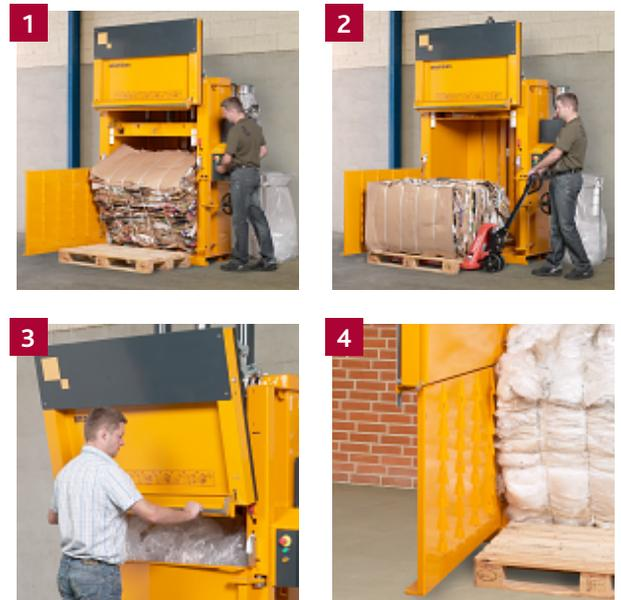
**1** Compacte los residuos y expulse la bala terminada. **2** Extraiga y almacene la bala hasta su recogida. **3** Con la puerta vertical puede disfrutar de una postura de trabajo ergonómica. **4** Hileras de púas en el interior de la cámara mantienen el material de residuo abajo.
