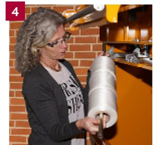
**1** Compact your waste and eject the finished bale. **2** Remove and store the bale until collection. **3** Con la puerta vertical puede disfrutar de una postura de trabajo ergonómica. **4** Los rollos de fleje se colocan delante. Son fáciles de remplazar
