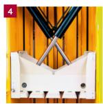
1 Compacte los residuos y expulse la bala terminada. 2 Extraiga y almacene la bala hasta su recogida. 3 La bala se expulsa mediante un proceso seguro con ambas manos. 4 Los cilindros cruzados garantizan una compresión estable y una altura global baja.
